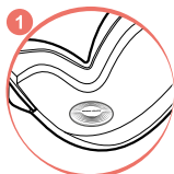
1 Posizionare il sensore pad sotto l'imbottitura del seggiolino
