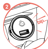
2 Il display emetterà dei bip per circa 20 secondi e la luce lampeggerà da verde a rossa
